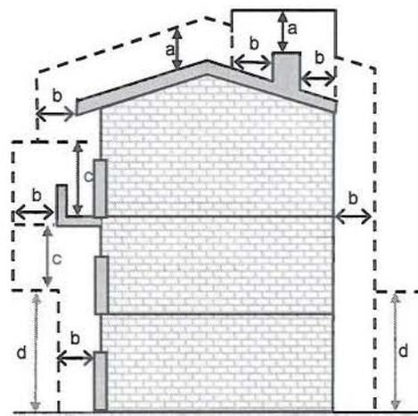
Figura 13.1. Distancias de seguridad en zonas con construcciones
