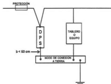
Figura 20.2 Montaje típico de DPS
