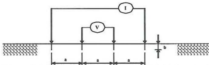
Figura 15.4. Esquema de medición de resistividad aparente
