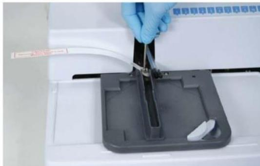
Figura 42. Fijación del bloqueo de transporte
