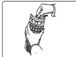
4. Vierta la mezcla de reactivo y la muestra directamente dentro del dispositivo Quanti-Tray, evitando tocar la lengüeta. Golpear los pequeños pocillos 2 ó 3 veces para eliminar posibles burbujas de aire. Deje reposar la espuma.
