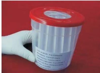
Figura 2. Vaso plástico con boca ancha para transporte o recolección de Triatominos.
