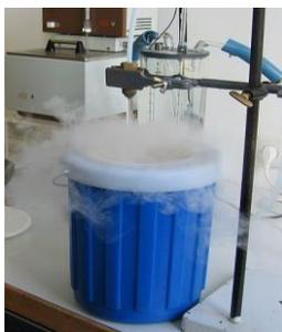
El contacto prolongado con el líquido refrigerante puede ser peligroso: quemaduras por frío y desprendimiento de vapores. También hay que tener en cuenta que, si se emplean para el control de reacciones exotérmicas, cualquier incidente que anule su función puede generar un incendio, una explosión o la emisión de sustancias tóxicas al ambiente de la reacción que se está refrigerando.
